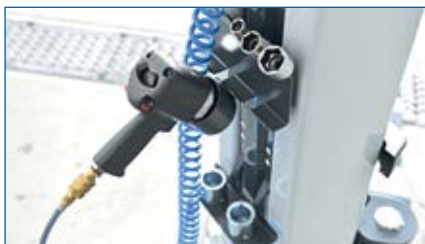
Schlagschrauberhalterung mit integrierter Ablage für Aufnahmeerhöhungen.
