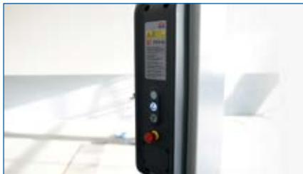
Zweite Bedieneinheit an Gegensäule verkürzt die Wege um die Hebebühne.
