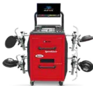
3D-Achsmessgerät mit batteriebetriebenen HQ-Messköpfen und Bluetooth-Datenübertragung.
